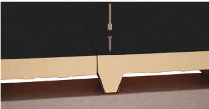
Das Bohrloch muss bis zur darunter befindlichen Sicke reichen.
