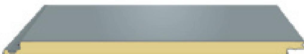
Isovision combine la beauté d'un mur architectural avec la praticité des constructions modulaires. Conçu pour les façades ventilées, il offre un réaménagement esthétique et énergétique de la structure, créant une couche ventilée et un confort thermique accru. Les panneaux sont ancrés en s'emboitant avec une fixation cachée. Isovision est disponible avec une finition de surface lisse.
