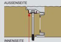
Lattonedil empfiehlt, bei der Montage die Befestigungsplatte aus Stahl zu verwenden. Die Platte hat die Aufgabe, die aus der Befestigung resultierenden Kräfte zu verteilen und den Widerstand gegen die auf die Wandpaneele wirkenden Zug- und Druckspannungen zu erhöhen. Die Position und die Anzahl der Befestigungspunkte müssen vom Planer in der Entwurfsphase auf Grundlage der auf das Bauwerk einwirkenden Spannungen festgelegt werden.
