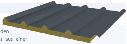
Jl Vulcasteel Roof ist ein isoliertes Dachpaneel für den Bau von Schrägdächern. Das Sandwichpaneel besteht aus einer trapezförmigen Außenplatte, einem Steinwollkern und einer leicht linierten Innenplatte. Durch die Dicke von bis zu 200 mm kann ein hohe Feuerbeständigkeit und Lärminderung erreicht werden. Kurz gesagt, die Lösung für Ihre Projekte in der Landwirtschaft, der Industrie, im Dienstleistungssektor und sogar im Wohnbereich mit Anforderungen an Schallabsorption und Feuerbeständigkeit.
