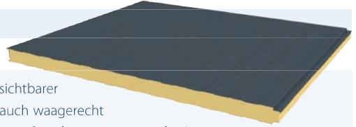
JI Wall PIR 40-60 mm (LL) ist ein isoliertes Paneel mit sichtbarer Montage. Dieses Wandpaneel kann sowohl senkrecht als auch waagrecht montiert werden. Das Sandwichpaneel besteht aus einer Außenplatte mit einem leicht linierten Profil, einem Kern aus Polyisocyanurat-Schaum (PIR) ohne schädliche FCKW-HCKW-Verbindungen und einer leicht linierten Innenplatte. Diese Innen- oder Außenwände sind eine geeignete Lösung für Ihre Projekte im landwirtschaftlichen, industriellen und Dienstleistungssektor.
