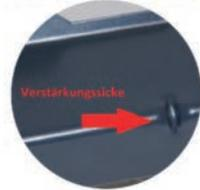
Die einzigartige Herstellung von Steirer Blech ermöglicht, dass der Schneeschutz in einem Teil aus dem Blech ausgestanzt wird. Dadurch sind die Eiskralen schon fix mit dem Blech verbunden. Zudem sind beim GS Schneeschutz schon werkseitig fixe EPDM Zellkautschukdichtungen aufgebracht. Die eingepresste Sicke im Bereich der Bugkante verstärkt das Profil nochmal zusätzlich. Durch die Federwirkung wird das darunterliegende Dachmaterial nicht beschädigt.
