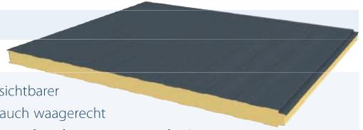
JI Wall PIR 40-60 mm (LL) ist ein isoliertes Paneel mit sichtbarer Montage. Dieses Wandpaneel kann sowohl senkrecht als auch waagrecht montiert werden. Das Sandwichpaneel besteht aus einer Außenplatte mit einem leicht linierten Profil, einem Kern aus Polyisocyanurat-Schaum (PIR) ohne schädliche FCKW-HCKW-Verbindungen und einer leicht linierten Innenplatte. Diese Innen- oder Außenwände sind eine geeignete Lösung für Ihre Projekte im landwirtschaftlichen, industriellen und Dienstleistungssektor.
