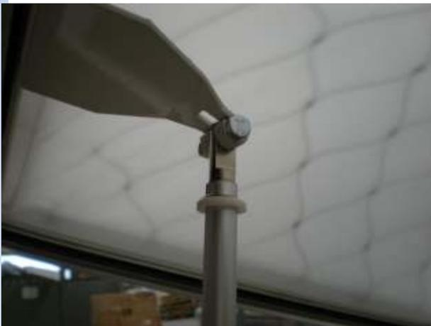
8. Elektromotor und Gelenksbrückenfahne mit M6x35 Schraube + Sicherungsmutter verbinden
