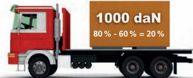
Es sind somit 20 % der Gewichtskraft (200 daN) an Sicherungskraft einzuleiten. Sicherungsbedarf (Formschluss nach vorne und ein Reibbeiwert von 0,6).
