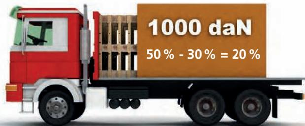
Es sind somit 20 % der Gewichtskraft (200 daN) an Sicherungskraft einzuleiten.
