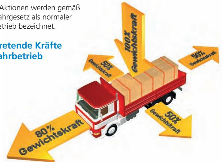
Die obige Grafik zeigt, welche Kräfte auf Grund physikalischer Zusammenhänge (Beschleunigungs-, Verzögerungs- und Fliehkräfte) auf die Ladung wirken und welcher Sicherheitsbedarf sich daraus ergibt. Diese Werte sind in der EN-12195-1 als Maximalwerte für die Berechnung von Zurrkräften angegeben.
