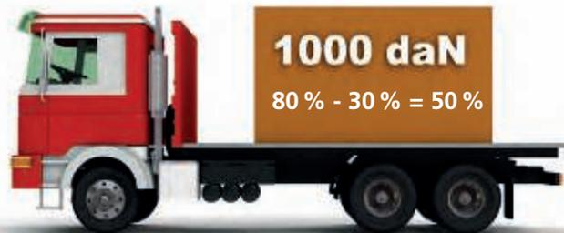
Es sind somit 50 % der Gewichtskraft (500 daN) an Sicherungskraft einzuleiten. Die Sicherungskraft zur Seite ist somit ebenfalls gewährleistet.
