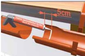
Mit PREFA Spezialkleber eine Kleberaube mit ca. 8 mm Dicke aufbringen
