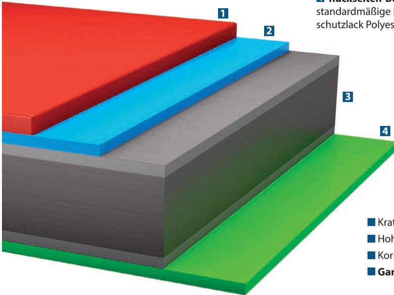
2-Schicht-System ca. 35 µm
