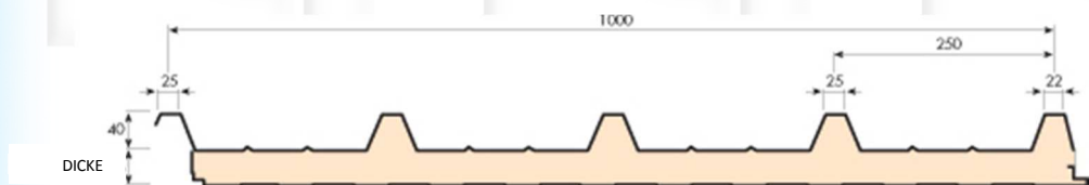
Dachpaneel ISOCOP -5, mit Außenprofilierung aus 5 Hochsicken mit einem Abstand von 250 mm-
