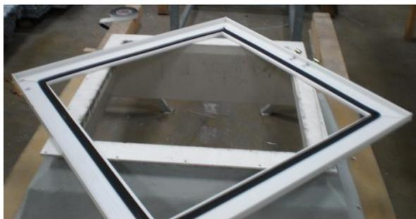
1. Adapterrahmen auf der Rückseite mit dem Dichtungsband bekleben.
