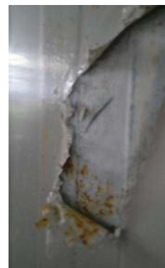
Beispiel von Oxidierung nach Blistering
